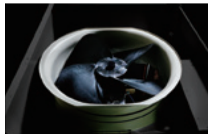
Nově navržený zakřivený výstupní otvor pro vypouštění vzduchu pro lepší aerodynamiku
