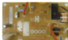
CZ-NS3P Obvodová deska pro připojení solární soupravy pro nedělené systémy 6 kW a 9 kW.
