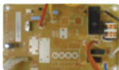
CZ-NS2P PCB pro připojení solární soupravy pro nedělené systémy.
