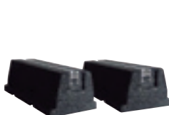
PAW-GRDBSE20 Venkovní základová podpěra pro absorpci hluku a vibrací (600×95×130 mm, 500 kg).
