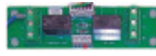
PAW-T10 Deska s elektronikou s rozhraním T10 s digitálními a reléovými spoji.
